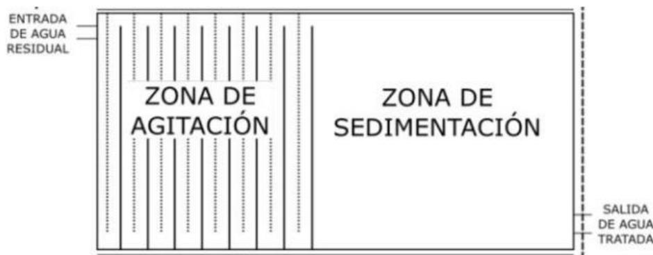
Figura 1. Diseño de sistema de electrocoagulación -electroflotación en sistema continuo
